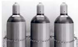
Figura 1: bombole a gas assicurate con una catena.
