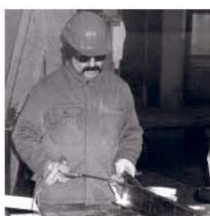
Figura 5: addetto alla saldatura a gas durante la frittura. Indossa occhiali di protezione (classe di protezione 4-7 secondo EN 169) e protettori auricolari.
